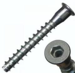
Шуруп-стяжка – применяемые во время сборки современной мебели метизы, создающие прочное соединение между такими материалами, как фанера, ДСП или ламинат. Крепежи производят из прочной углеродистой стали, которую пассируют и покрывают цинковым сплавом.
